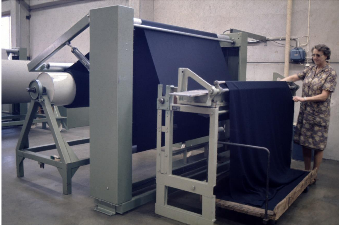
Etter kontroll på Nuppen var det tid for varmebehandling i fikseringsmaskinen slik at drestøyene tålte strykejern. Martha Jordebekk tar en siste sjekk etter behandlingen. Bilde: Undheim/Vigesdal
