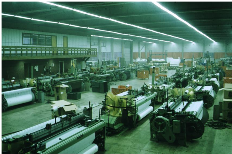
Vevstoler av typen Sulzer i det nye veveriet fra 1970. Nå Norwegian Outlet. Bilde: Undheim/Vigesdal
